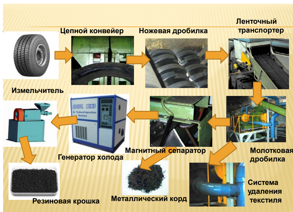
Рис. 3. Технологическая схема получения резиновой крошки
