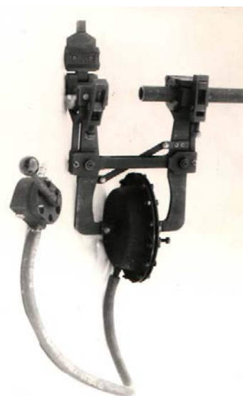
Рис. 4. Переносное устройство для газопрессовой сварки труб диаметром 6–50 мм
