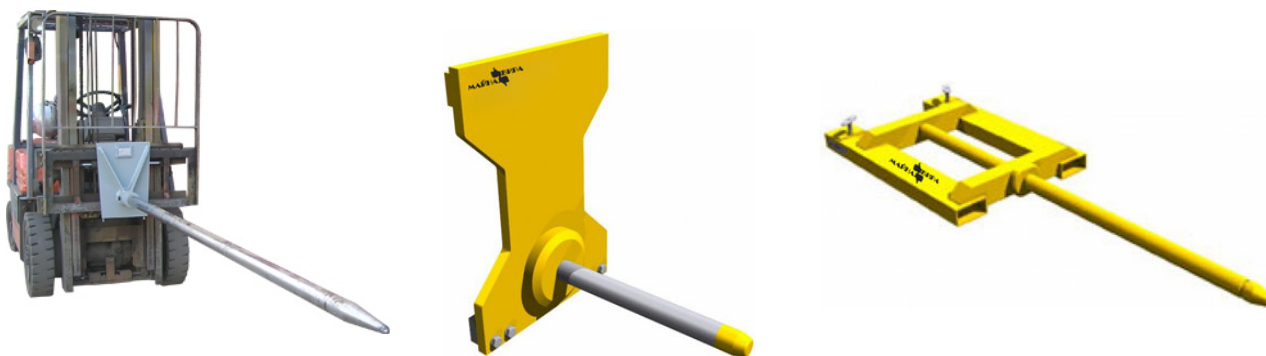
Рис. 1. Внешний вид автопогрузчика и способы крепления горизонтального штыревого захвата
