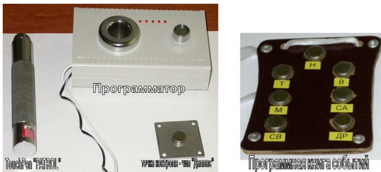
Рис. 7. Элементы системы контроля Touch Memory
