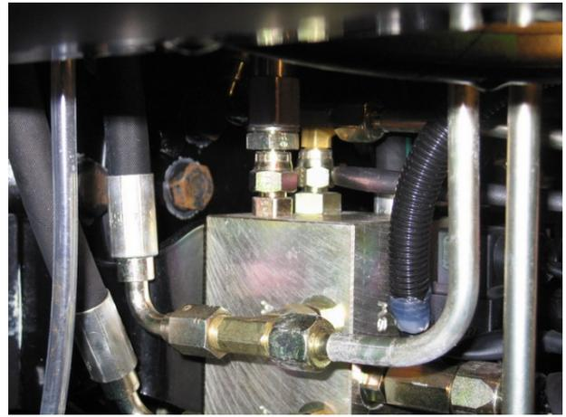
**Рис. 7.** Место расположения регулировочных винтов гидроаккумуляторов тормозов (левый рисунок) и регулировки давления стояночного тормоза
