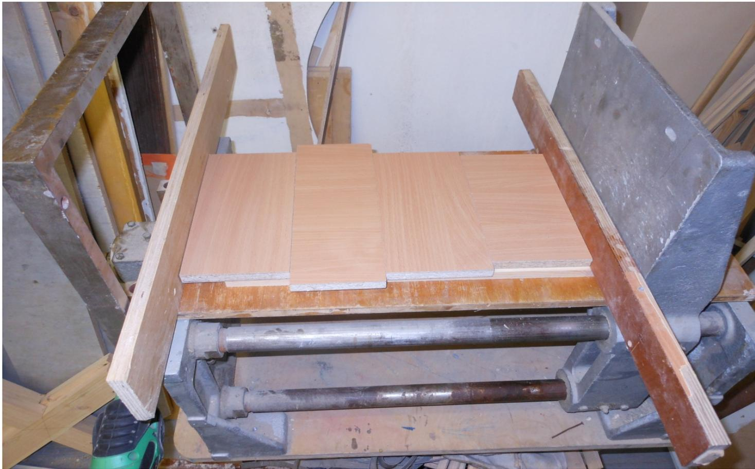
При сжатии заготовки приподнимались и образовывались неровности уровней поверхностей на клеевых швах
