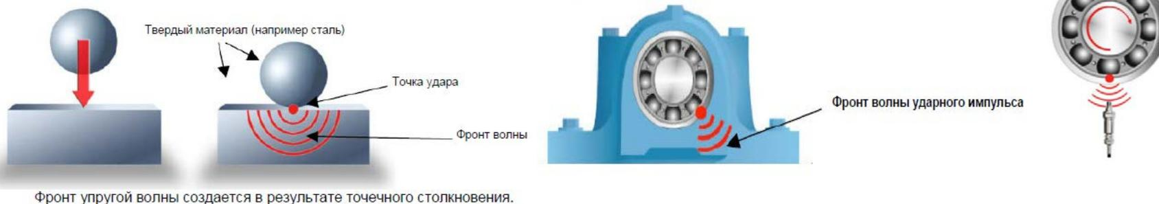
2. С помощью метода SPM основные причины появления дефектов подшипников – погрешности монтажа и плохая смазка – быстро и легко обнаруживаются.
