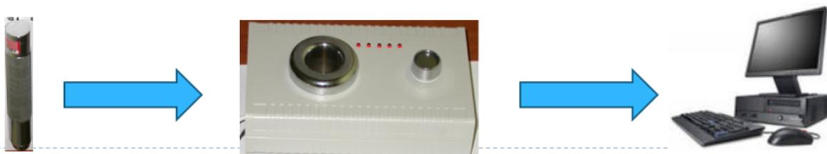
**Рис. 8.** Порядок обхода оборудования с помощью системы контроля Touch Memory
