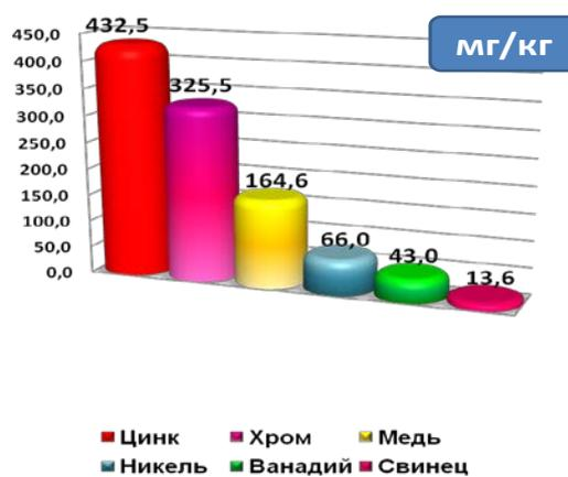
**Рис. 7.** Анализ компонентного состава зольного остатка, полученного при сжигании корьевых отходов
