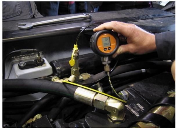
**Рис. 3.** Место расположения клапана регулировки давления поворота полурам машины
