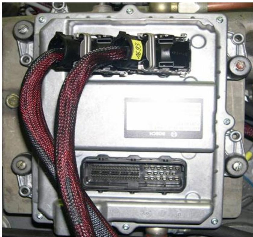
**Рис. 6.** Электронный блок управления EDC7UC31 фирмы «Bosch»
