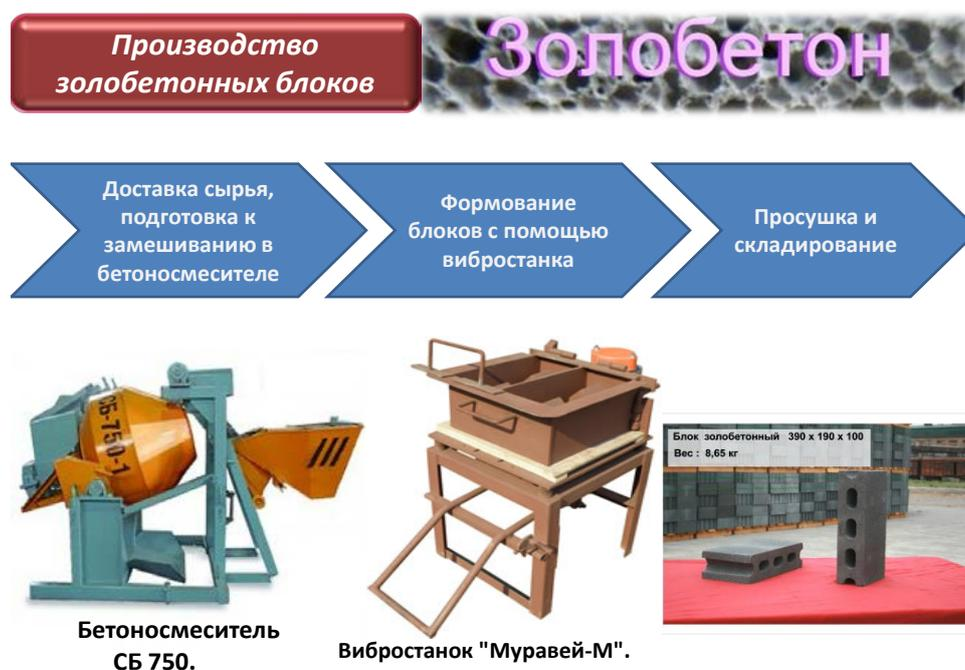
**Рис. 8.** Схема и оборудование для производства золобетона
