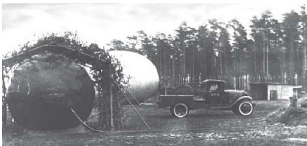
**Рис. 1.** ГАЗ-АА на водороде
