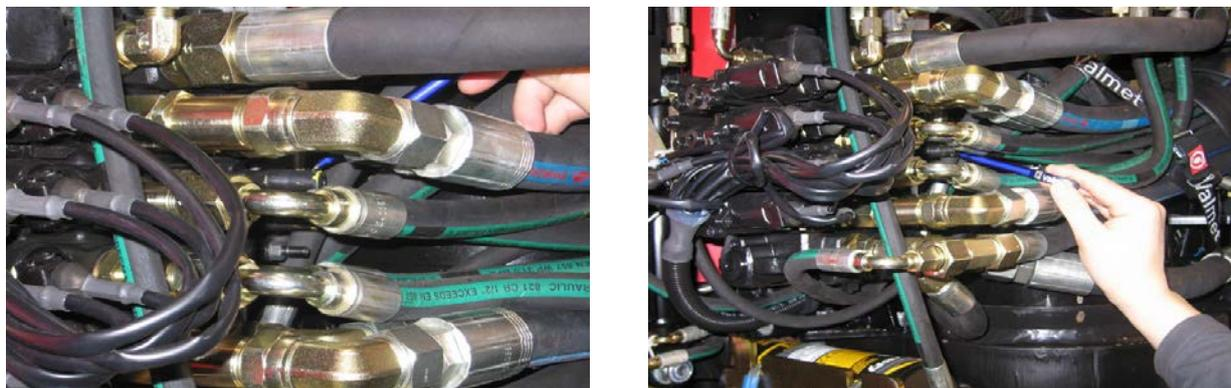
**Рис. 5.** Точки регулировки подъема и отпущания стрелы.
