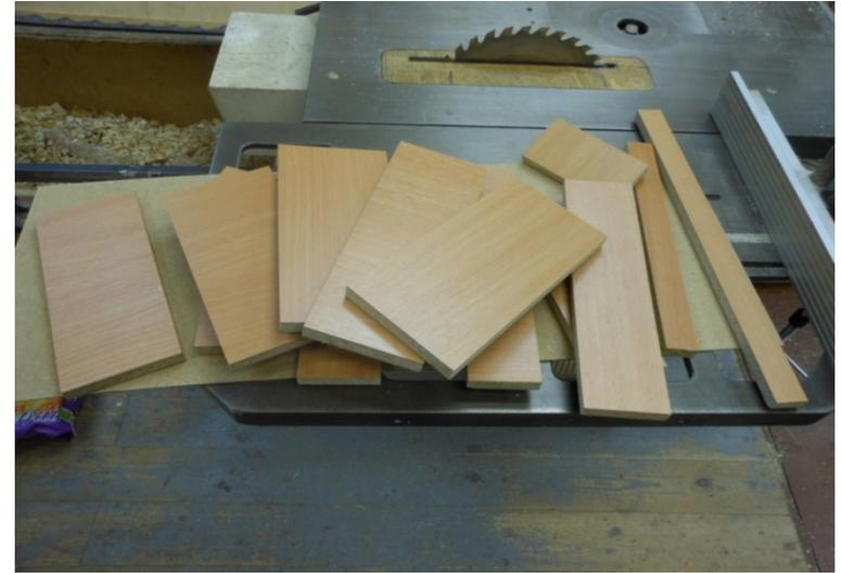
1. В мебельном производстве основное количество отходов образовывается при раскрое плит на заготовки.
