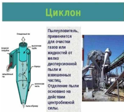
Рис. 9. Технические характеристики циклона ЦН-11
