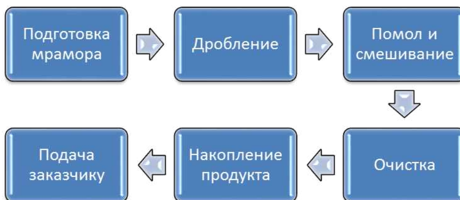
Рис. 2. Технологическая схема производства суспензии измельченного карбоната кальция
