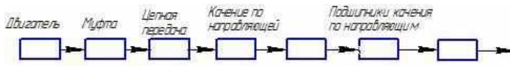
Рис. 3. Структурная схема привода подачи станка ШО 16-4
