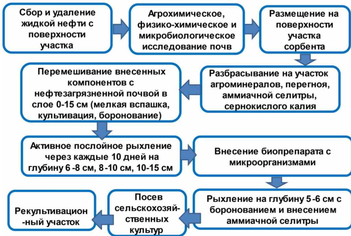
Рис. 6. Алгоритм работы на аварийном участке
