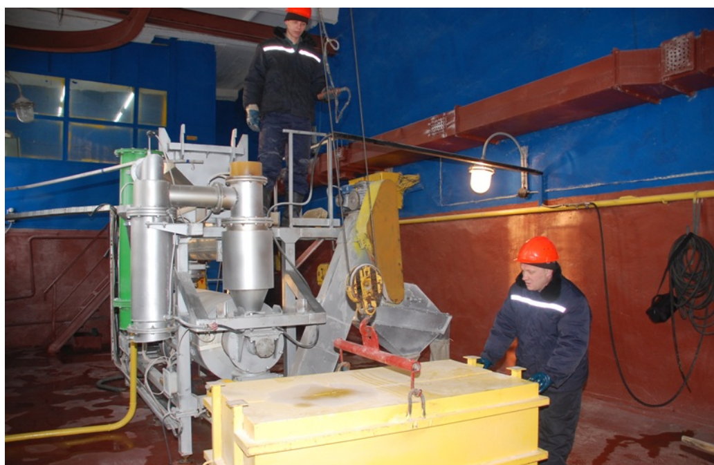
Рис. 2. Установка демеркуризации ртутьсодержащих ламп УДМ-3000
