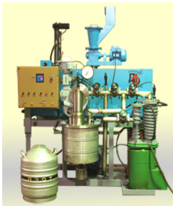
Рис. 1. Установки демеркуризации ртутьсодержащих ламп УРЛ-2М и «Экотром-2»
