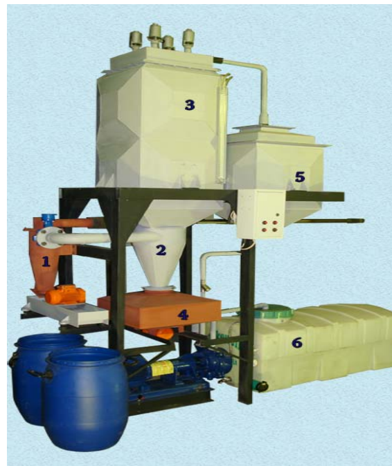
Рис. 1. Установки демеркуризации ртутьсодержащих ламп УРЛ-2М и «Экотром-2»
