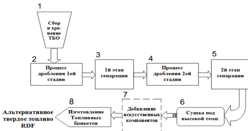
Рис. 2. Технологическая схема производства альтернативного твердого топлива RDF:
