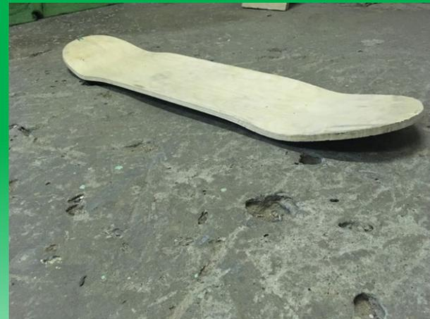
Заготовка после обрезки
