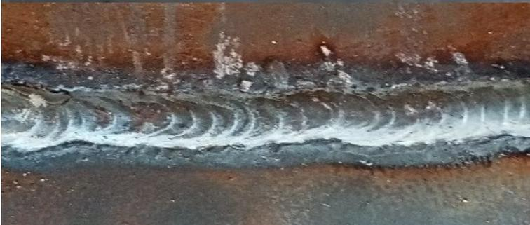
**Рис. 4.** Сварной шов, полученный при сварке способом MIG
