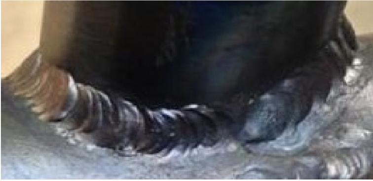
**Рис. 5.** Сварной шов, полученный при сварке способом TIG
