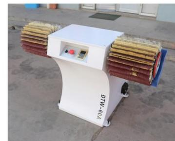
Рисунок 4 – Шлифовальный станок
