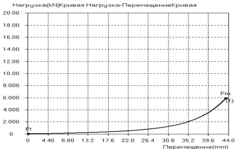
Разрушение экоэлстара на основе столярной стружки
