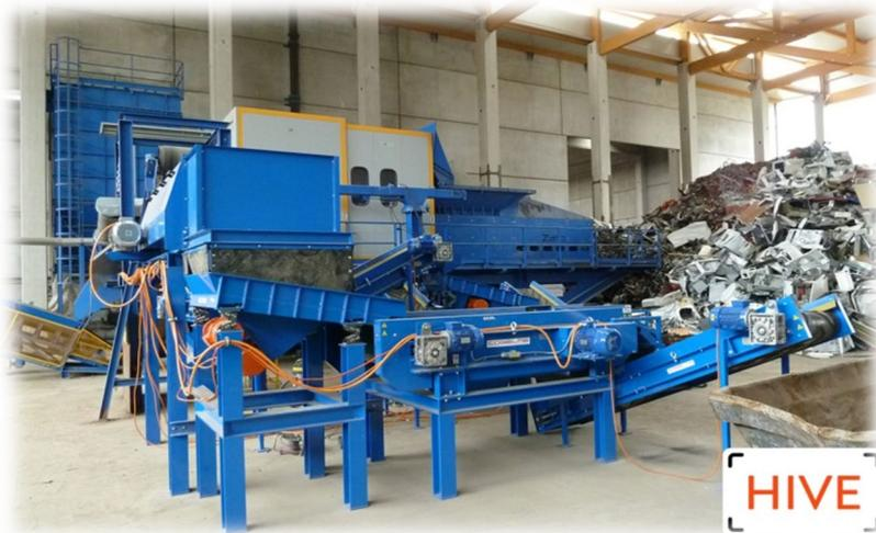
Для отделения цветных металлов служит вихрекоковый сепаратор. Благодаря вихревым токам машина генерирует магнитные поля, вращающиеся с большой скоростью, выбрасывая цветные металлы
