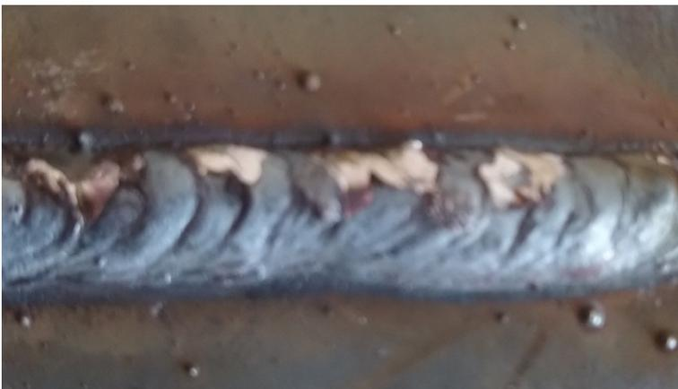
**Рис. 3.** Сварной шов, полученный при сварке способом MAG
