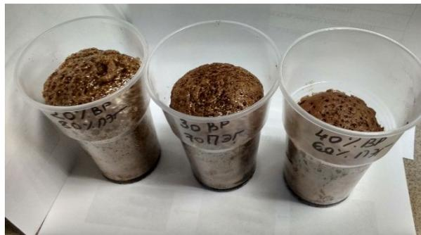
**Рис. 3.** Пенополиуретановая композиция, полиольный компонент которого на 40 % замещен биополиолами
