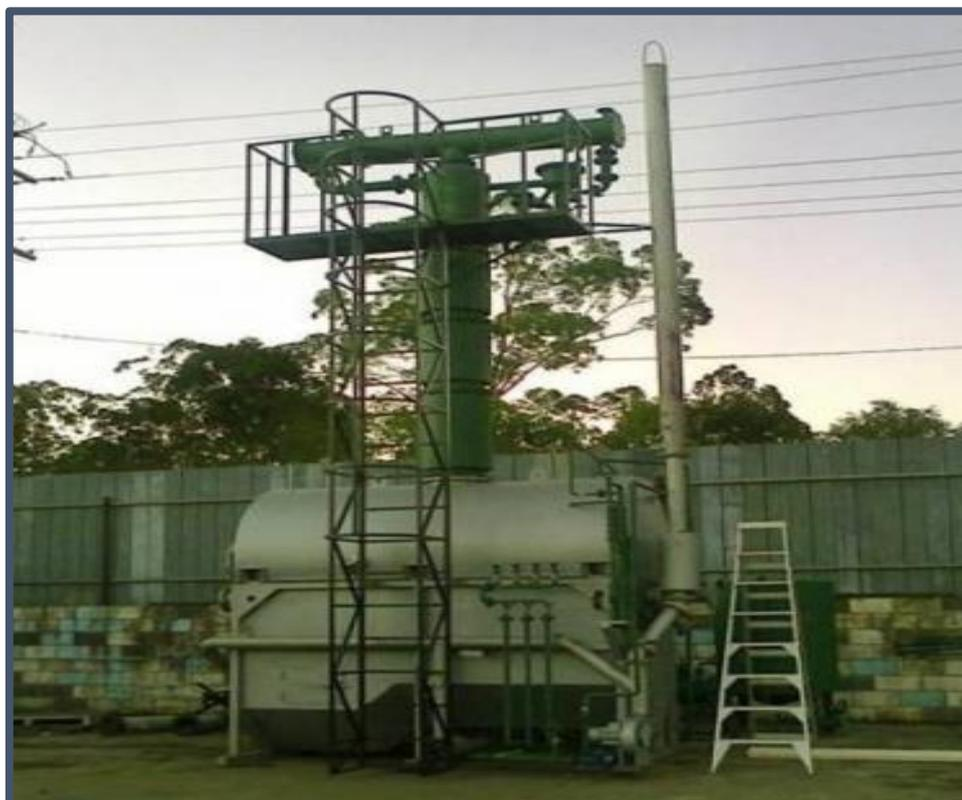
**Рис. 5.** Установка вакуумной ректификации SS-V4
