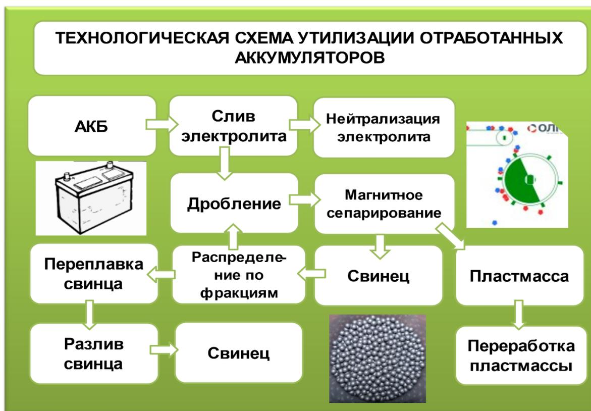
Рис. 5. Технологическая схема утилизации отработанных АКБ
