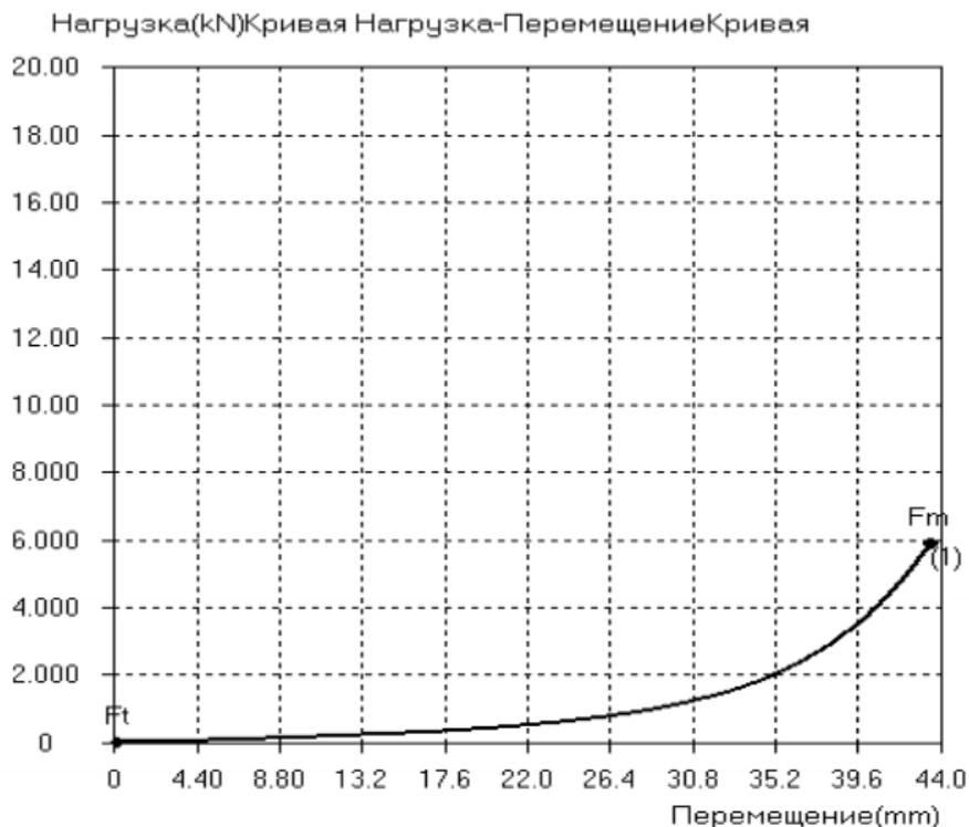
**Рис. 2.** Разрушение ЭКОпродукта на основе столярной стружки (хвойная порода — сосна)
