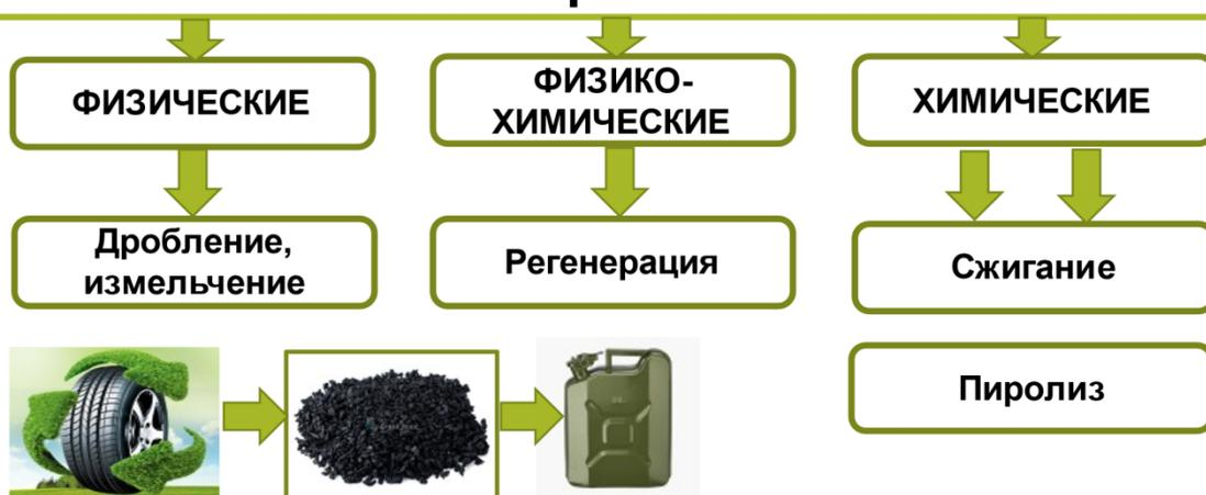
Рис. 3. Способы переработки отработанных автопокрышек
