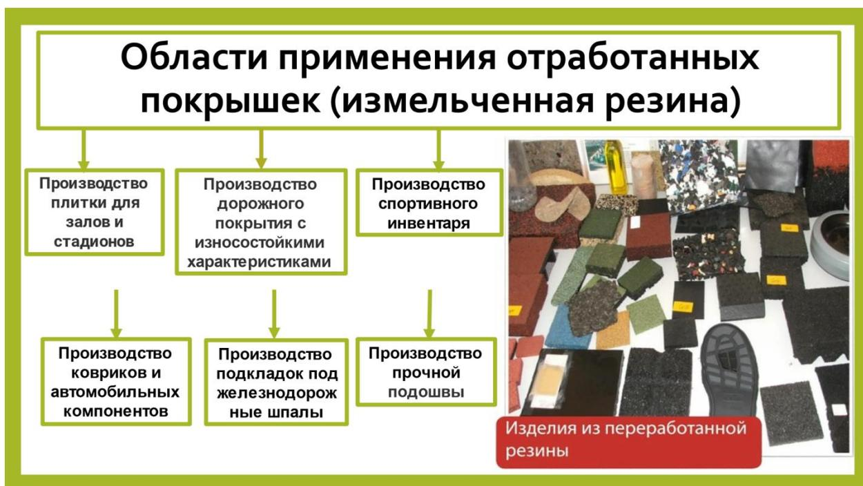
Рис. 4. Области применения отработанных автопокрышек в виде измельченной резины
