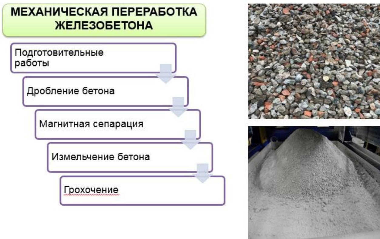
**Рис. 3.** Технологическая схема утилизации бетонных отходов и получаемая продукция
