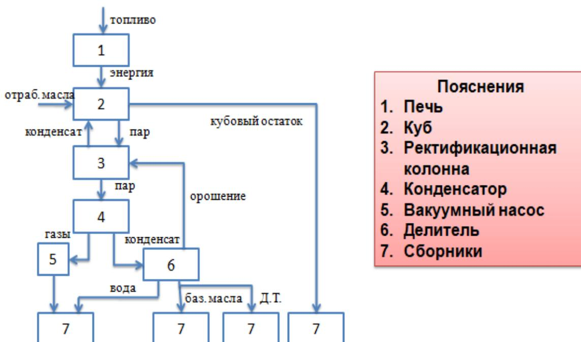
**Рис. 4.** Технологическая схема утилизации отработанных масел
