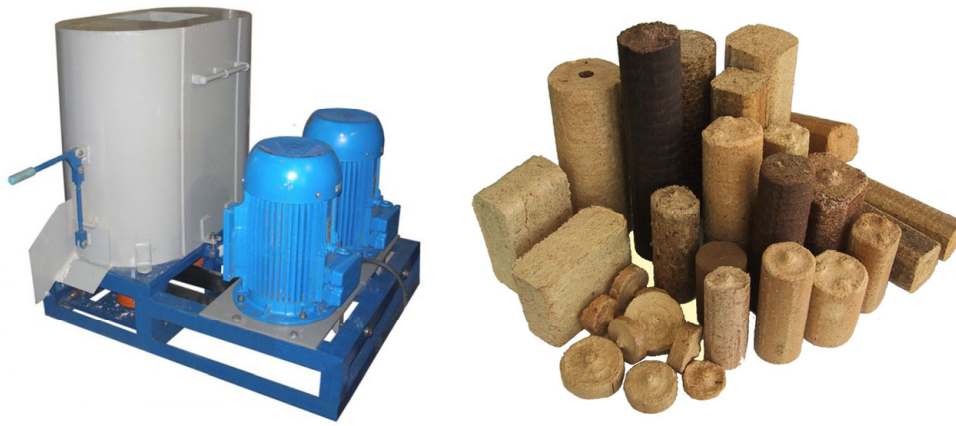
Рис. П1.8. Пресс штемпельный для брикетирования древесных отходов (слева) и продукция брикетирования (справа)
