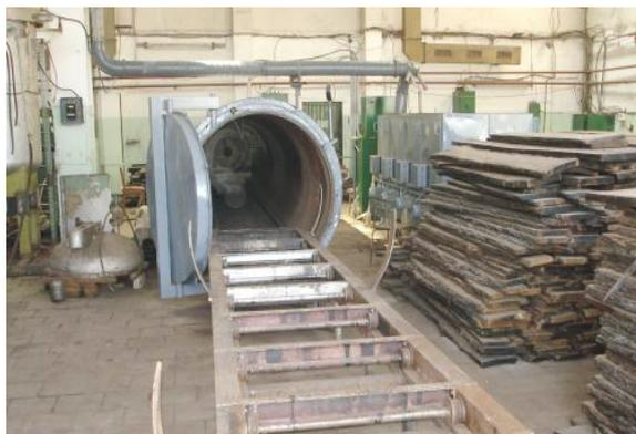
**Рис. 2.** Установка механохимической модификации древесины
