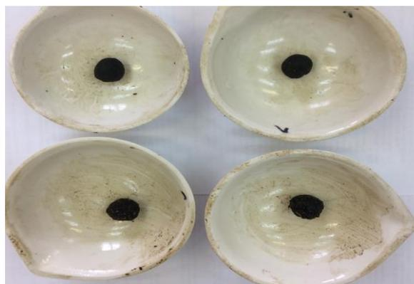
Рис. 6. Готовые древесно-топливные окатыши, полученные в лабораторных условиях
