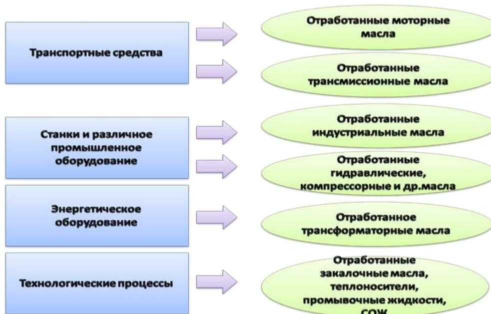
**Рис. 1.** Источники образования отработанных масел
