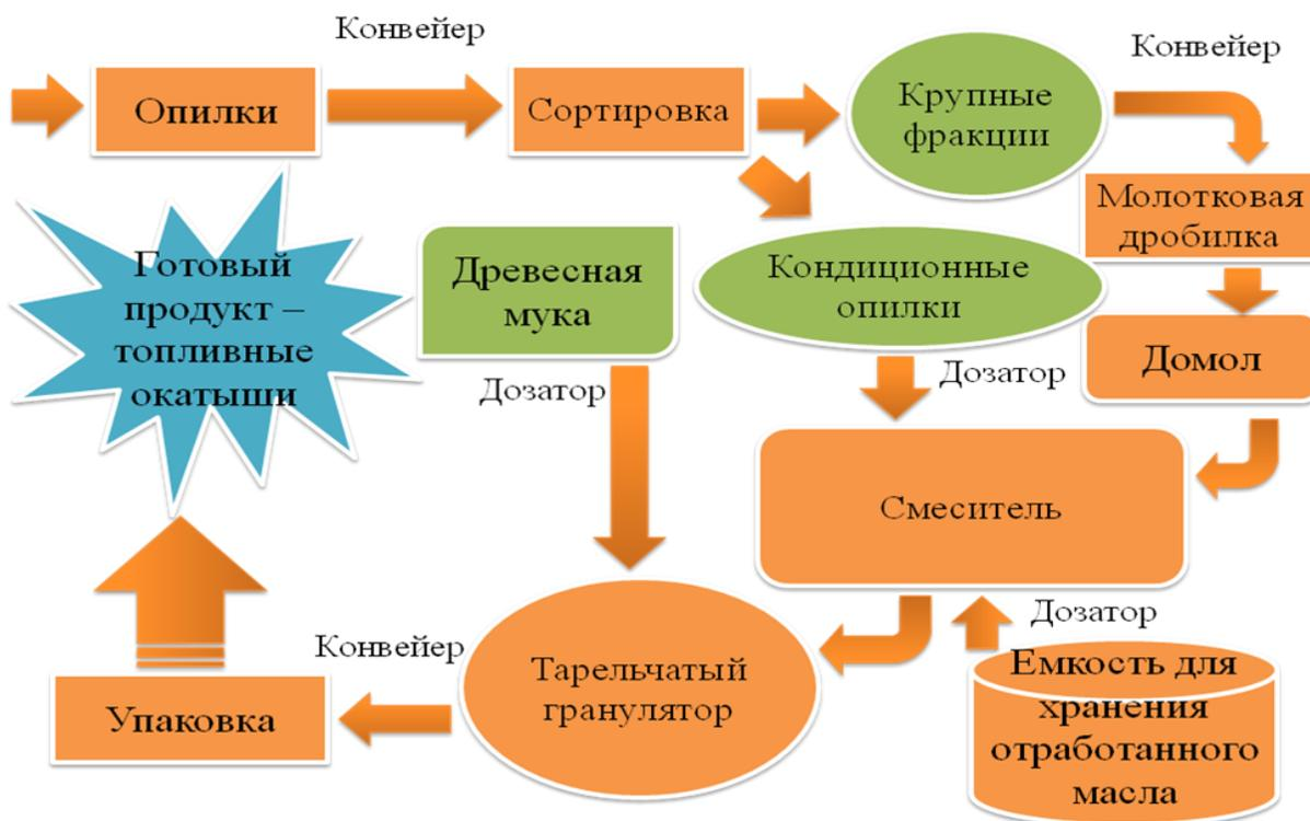
Рис. 7. Принципиальная технологическая схема производства древесно-топливных окатышей
